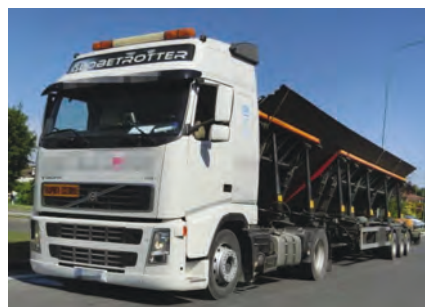
Figuur 14: Stalen platen vervoerd onder een hoek van 45°
