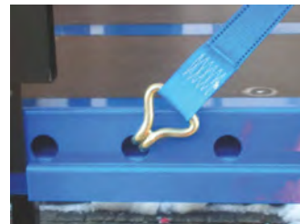
Figuur 13: Bevestigingsgat in zijprofiel
