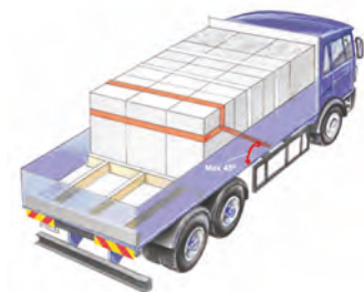
Figuur 40: Kopsjorren met behulp van een band
