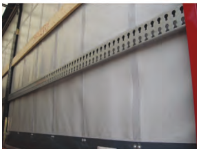
Figuur 27: Aluminium lat met gaten voor stuwbalken
