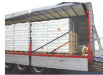
Figuur 39: Kopsjorren met behulp van pallets
