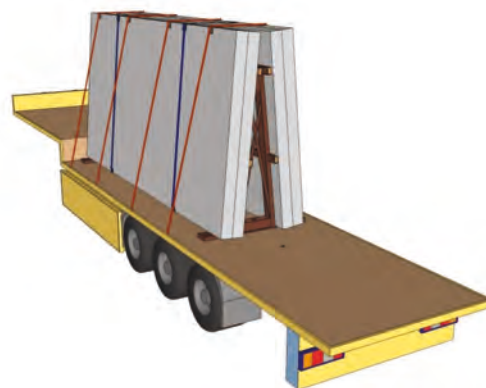
Figuur 48: Zekering d.m.v. een combinatie van opsluiten, A-frame, sjorring rondom en neersjorring
