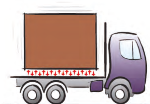
Figuur 3: Verticale trillingen tijdens het rijden
